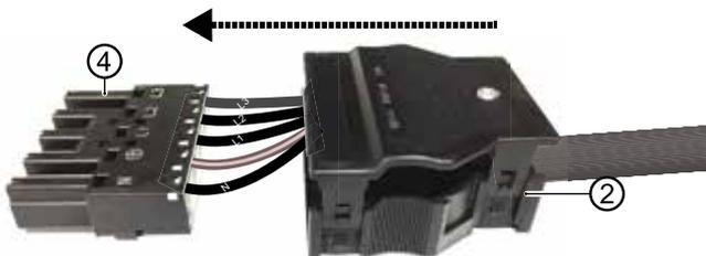
1.7. Korrekt aneinander ausrichten: Oberseite Buchse und Oberseite Zugentlastungsgehäuse sind jeweils durch aufgeprägte Markierungen „TOP“ gekennzeichnet.
