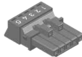
2.1. Kontaktfeder (5) in Pin 3 (6) bis zum Anschlag einbringen.
