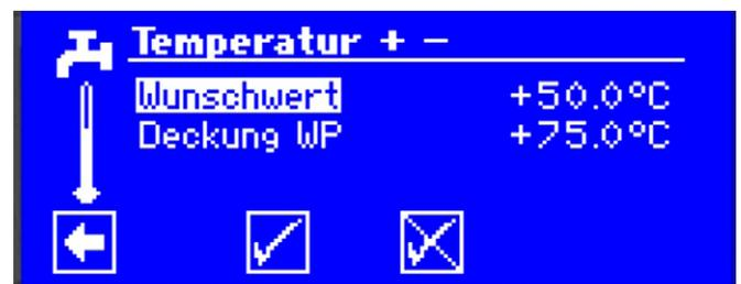
Wir empfehlen den Wunschwert des Reglers auf die im Solar Manager eingegebene „Brauchwasser-Temperatur Reduziert“ zu stellen. Wenn der Wunschwert höher eingestellt wird als die übermittelte Temperatur vom Solar Manager, wird der Grundbedarf bis zum Wunschwert ohne Leistungsreduzierung bereit.
