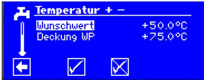
Im Heizungsmodus wird der Grundbedarf in erster Linie von der eingestellten Heizkurve inklusive eventuellen Offset vorgegeben.
