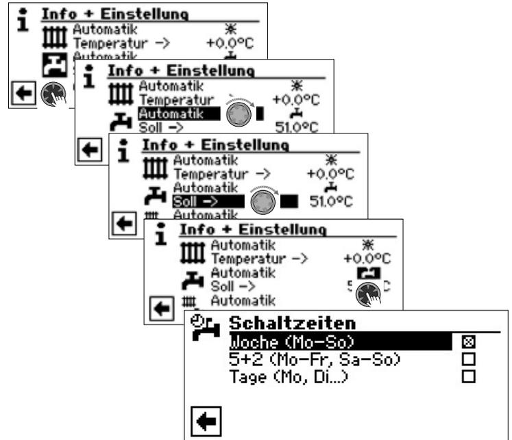
→ Die Programmierung der Schaltzeiten für die Trinkwarmwasserbereitung erfolgt wie im Abschnitt „Einstellen der Schaltzeiten des Heizkreises“ (ab Seite 11) beschrieben.
