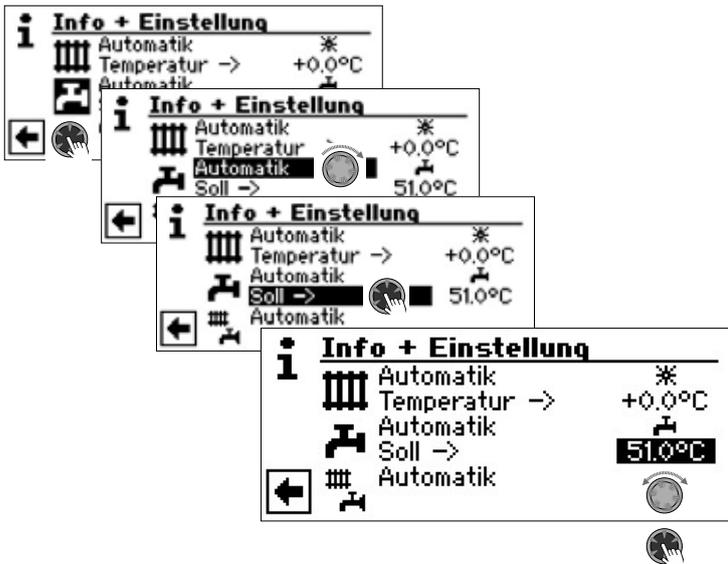
Gewünschte Trinkwarmwassertemperatur (= Sollwert) einstellen. Mindestwert: 30 °C. Eingabe durch Drücken des „Dreh-Druck-Knopfes“ beenden. Die gewünschte Temperatur wird dadurch gespeichert.
