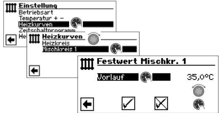
Ist die Option „Festtemperatur“ durch die Systemeinstellung eingeschaltet, wechselt der Bildschirm in das Menü „Heizkurven“ (von dem ausgehend Sie in die Menüs „Festwert Mischkr. 1“ gelangen)
