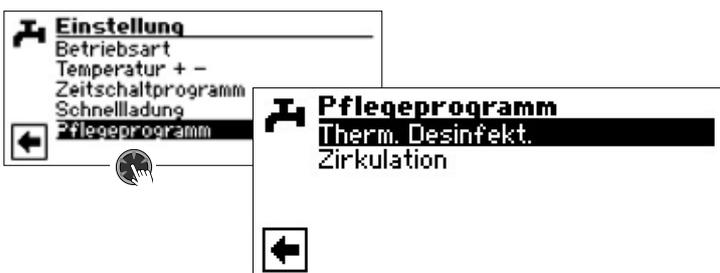
Die thermische Desinfektion ermöglicht, die Trinkwassertemperatur mit einem zusätzlichen Wärmeerzeuger (ZWE) auf eine höhere Temperatur zu bringen als jene, die mit der Wärmepumpe erreichbar ist. Die thermische Desinfektion wird ausschließlich über zusätzliche Wärmeerzeuger bereit; der Verdichter der Wärmepumpe bleibt ausgeschaltet.
