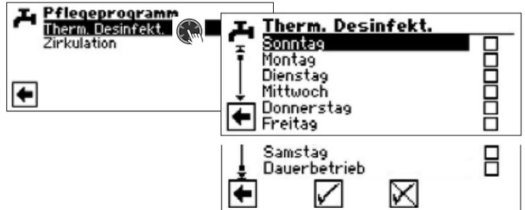
Tag(e), an dem (denen) eine thermische Desinfektion erfolgen soll, ansteuern und auswählen.
