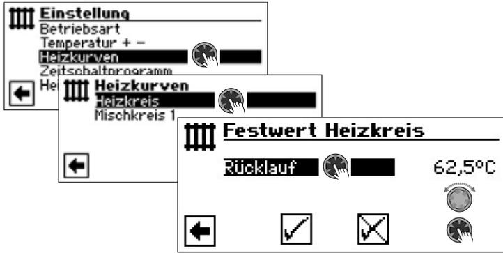
Ist die Option „Festtemperatur“ durch die Systemeinstellung eingeschaltet, wechselt der Bildschirm in das Menü „Heizkurven“ (von dem ausgehend Sie in die Menüs „Festwert Heizkreis“ gelangen) oder direkt in das Menü „Festwert Heizkreis“.
