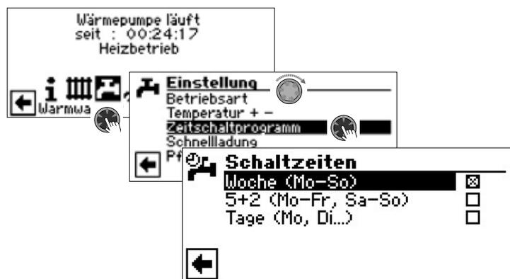
→ Die Programmierung der Schaltzeiten für die Trinkwarmwasserbereitung erfolgt wie im Abschnitt „Einstellen der Schaltzeiten des Heizkreises“ (ab Seite 11) beschrieben.
