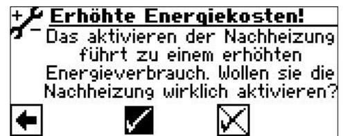
Bestätigen Sie dies, bleibt die Funktion „Trinkwarmwassertemperatur mit Nachheizung“ aktiviert und Sie können fortfahren.
