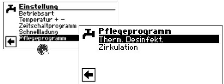
Die thermische Desinfektion ermöglicht, die Trinkwarmwassertemperatur mit einem zusätzlichen Wärmeerzeuger (ZWE) auf eine höhere Temperatur zu bringen als jene, die mit der Wärmepumpe erreichbar ist. Die thermische Desinfektion wird ausschliesslich über zusätzliche Wärmeerzeuger bereitet; der Verdichter der Wärmepumpe bleibt ausgeschaltet.
