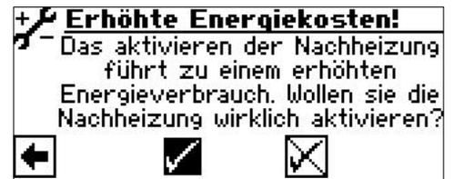
Bestätigen Sie dies, bleibt die Funktion „Trinkwarmwassertemperatur mit Nachheizung“ aktiviert und Sie können fortfahren.
