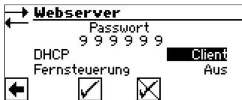
Der Heizungs- und Wärmepumpenregler bezieht dann seine Verbindungsdaten automatisch von dem DHCP-Server (z.B. Router).
